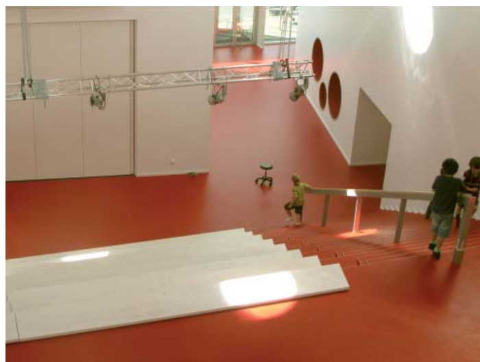
Mastertop 1325 anvendt i amfiteatret på gulv, trapper og "glughuller" i væggen til at sidde i.
