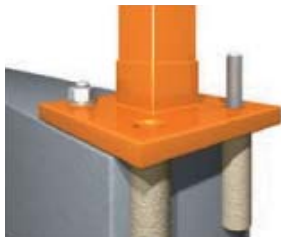
Fastgøring i beton iht. ETAG N° 001
